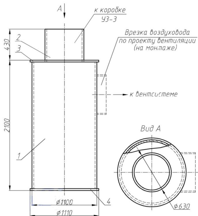
Рис.1. Монтажный чертеж расширительной камеры РК -2 -1.
